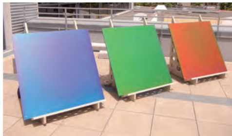
MorphoColor® – Eine Fraunhofer ISE-eigene Entwicklung für farbliche und zugleich hocheffiziente bauwerkintegrierbare PV-Module
